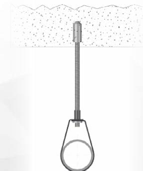
Varilla roscada y taco expansivo se proveen por separado
